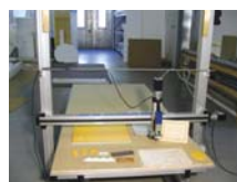
Glodalica za Y i Z osovina sa 500W motorom za glodanje plexi glassa, drva i PVC
